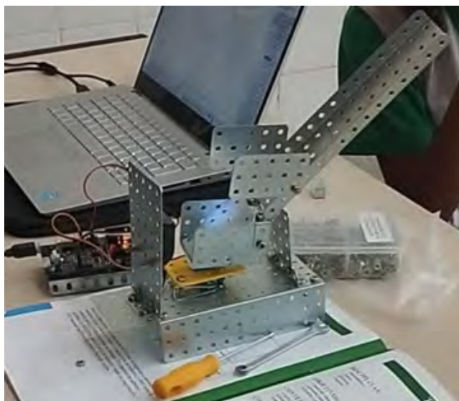
Figura 5 – Imagem do modelo do separador automático de lixo montado sendo testado.
