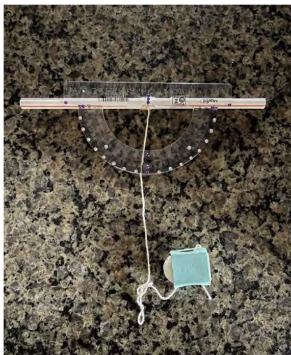
Figura 01 – Teodolito caseiro adaptado construído.
